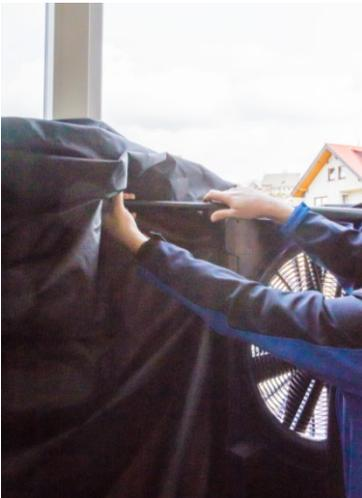
Abb. 16: Ventilatoreinheit wird mit Teleskopstange in Fenster eingespannt
