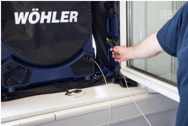
Abb. 20: Der Kapillarschlauch wird durch die Folie nach außen geführt
