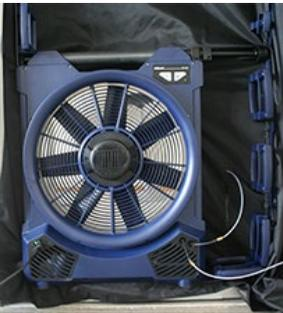
Abb. 21: Ventilatoreinheit mit Netzkabel und Kapillarschläuchen
