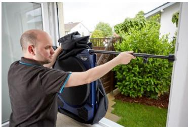
Abb. 13: Einspannen der Teleskopstange in den Fensterausschnitt
