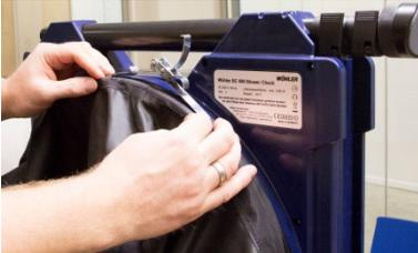
Abb. 12: Spannband um Ventilatorrand verschließen
