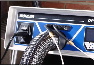
Fig. 34: Raccorder les tuyaux capillaires pour mesurer la pression différentielle
