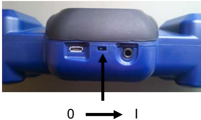
Fig. 3: Sperrschalter auf der Unterseite des Wöhler L 200
