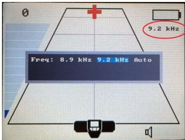
Ill. 4: Menu de sélection de la fréquence. La fréquence sélectionnée apparaît dans le coin supérieur droit de l'écran, ici marquée dans l'image.
