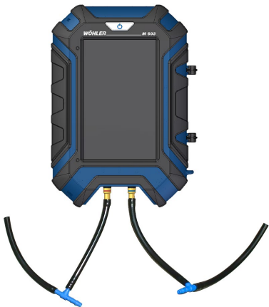
Abb. 8: Anschlüsse für die Differenzdruckmessung am Gas-Gebläsebrenner
