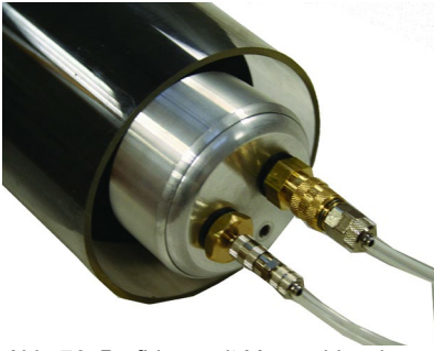
Abb. 76: Prüfblase mit Messschlauch und Schlauch zur Luftpumpe
