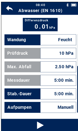
Abb. 77: Voreinstellungen Dichtheitsprüfung Abwasserleitung
