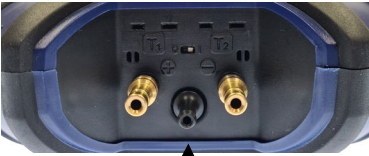
Abb. 36: Ansaugstutzen im Gasblasenanschluss
