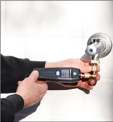
Abb. 63: Beispiel Anschluss Wöhler SC 660 an Wasserleitung
