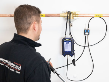
Abb. 7: Anschlussarmaturen für manuelles Aufpumpen
