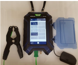
Abb. 10: Anschluss einer Temperaturmesszange
