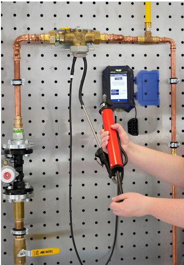
Abb. 44: Manuelle Volumenmessung mit Wöhler M 603 und Rußtestpumpe
