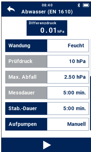
Abb. 72: Einstellungen zur Dichtheitsprüfung Abwasser
