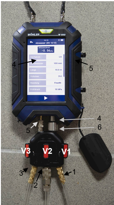
Abb. 71: Ventilblock mit Anschlüssen zum Wöhler M 603, zur Luftpumpe und zur Abdichtblase
