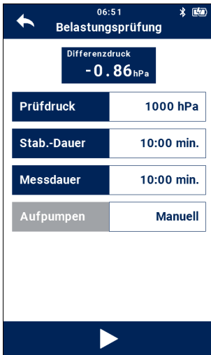
Abb. 22: Voreinstellungen zur Belastungsprüfung
