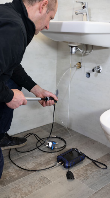
Abb. 57: Anschlussbeispiel mit dem Wöhler Gasleitungsdichtheitsprüfset für die Belastungsprüfung
