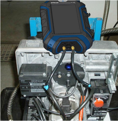
Abb. 9: Wöhler M 603 an den Gasgebläsebrenner angeschlossen (für die Differenzdruckmessung)
