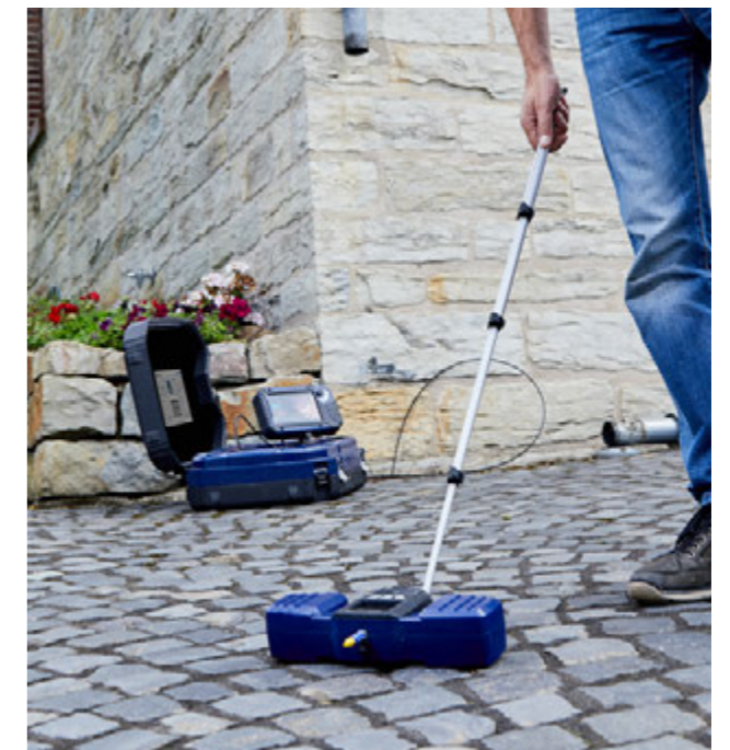
Mit dem Wöhler L 200 Locator lässt sich der Kamerakopf punktgenau orten.
