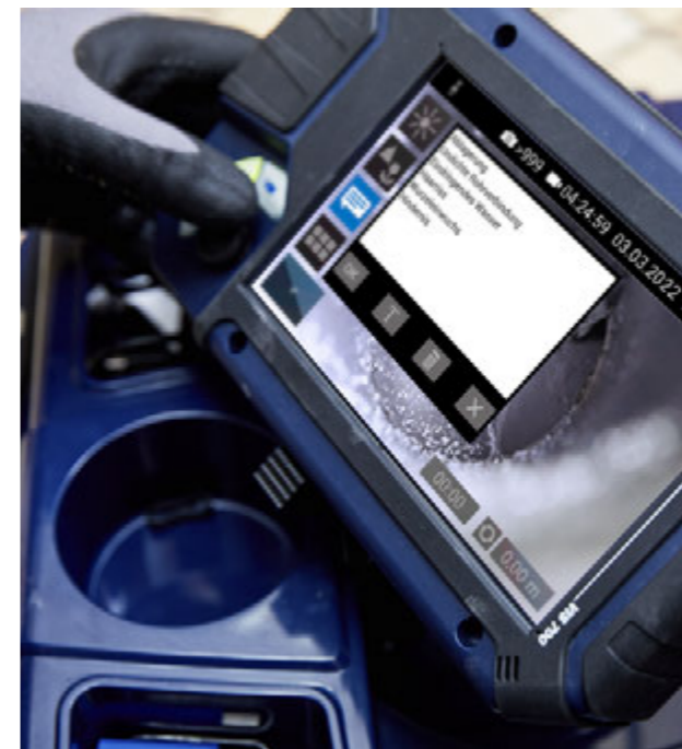
Jedem Bild lässt sich ein eigener oder vorgefertigter Kommentar hinzufügen. Sprachkommentare zu Videoaufnahmen sind ebenfalls möglich.
