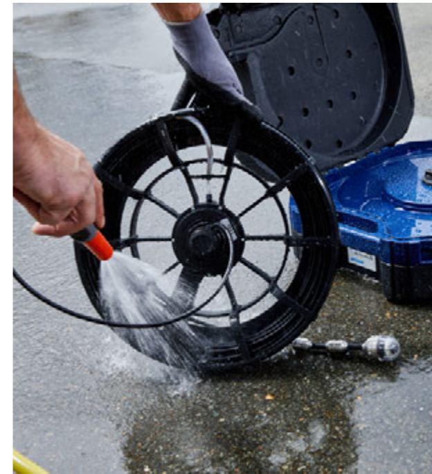
Schnelle Reinigung für dauerhafte Hygiene: Der robuste Koffer und die Haspel mit der Glasfaserstange können einfach abgespritzt werden.
