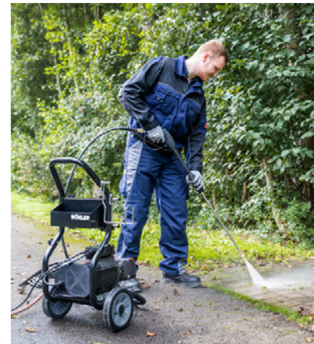
Reinigung mit der Lanze – Auswahl zwischen 5 Düsen ist möglich.
